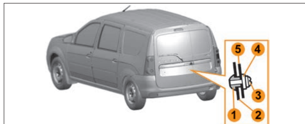
Рис. 5.1.2. Установка заднего номерного знака
