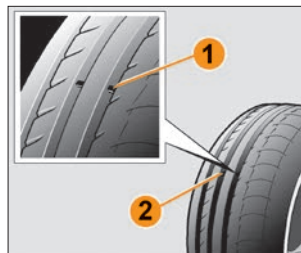
Рис. 6.9.4. Выступы-индикаторы на шинах
