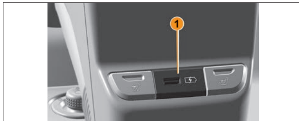
Рис. 4.4.4. USB-розетка 5 В (в варианном исполнении)
