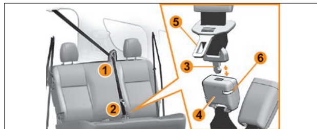
Рис. 2.5.5а. Фиксация среднего ремня безопасности без пассажира
