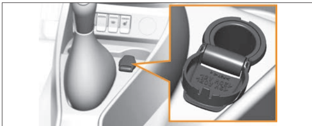
Рис. 4.4.1. Розетка 12 В для водителя и переднего пассажира
