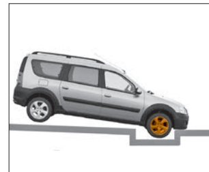
Рис. 2.6.7. Пример ситуации с возможным срабатыванием фронтальных подушек безопасности при падении или тряске на глубоких выбоинах
